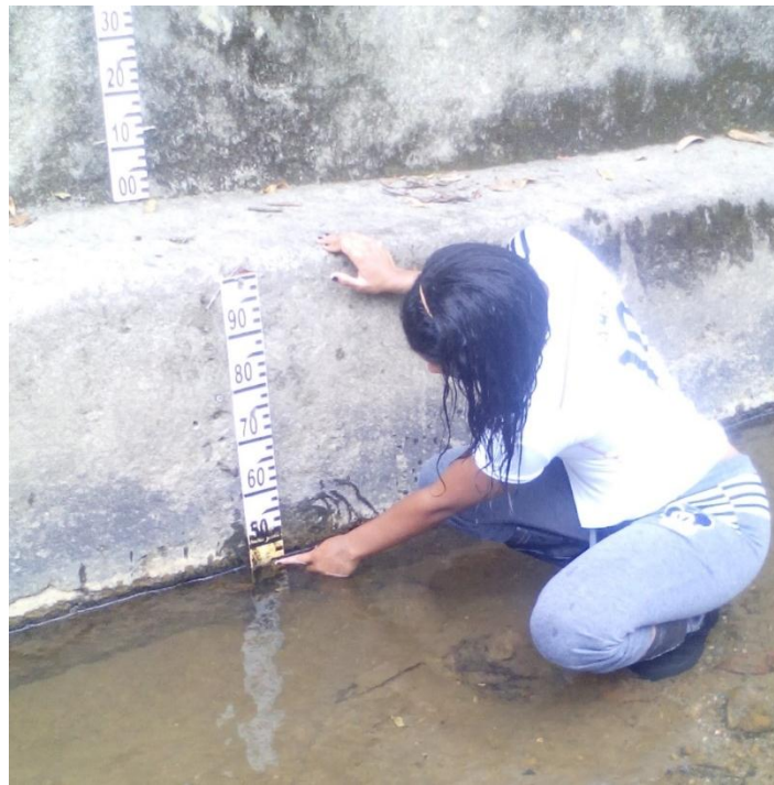
Figura 7. Toma de nivel de la regleta.
