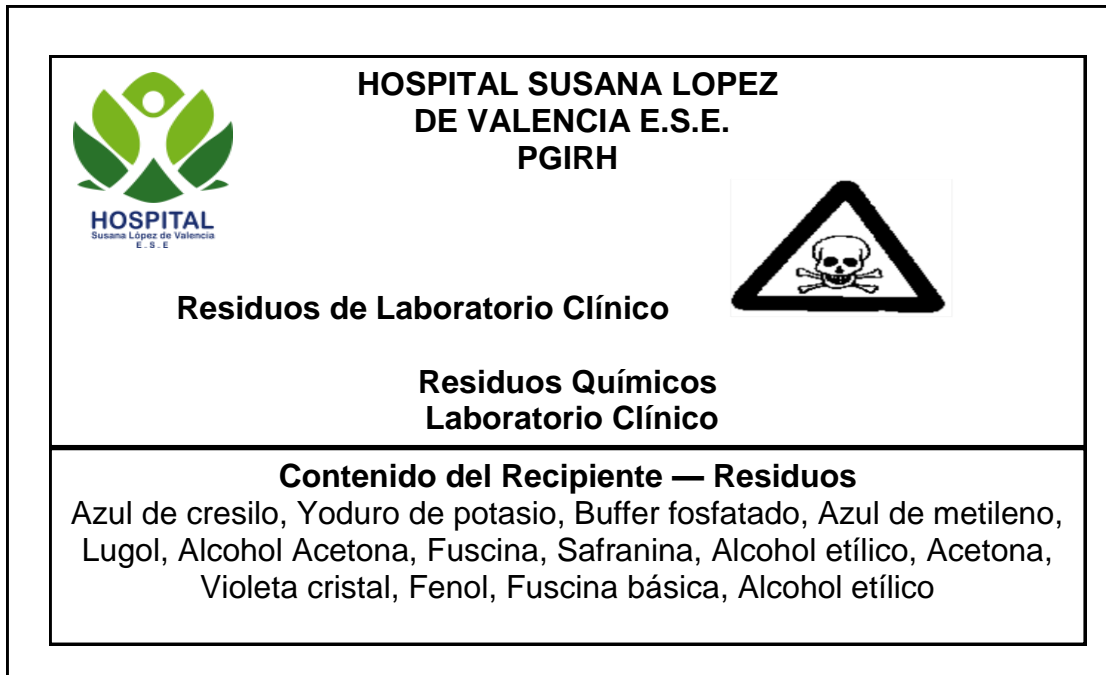
Figura 5. Adhesivo informativo de seguridad del recipiente de residuos líquidos de laboratorio clínico
