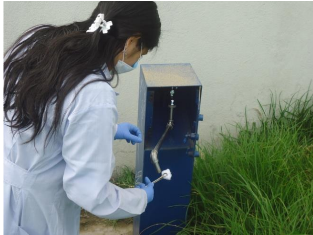
Figura 61. Esterilización de grifo para toma de muestra.
