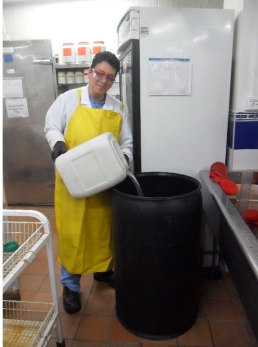
Figura 2. Elaboración de mezcla compuesta de agua residual tratada
