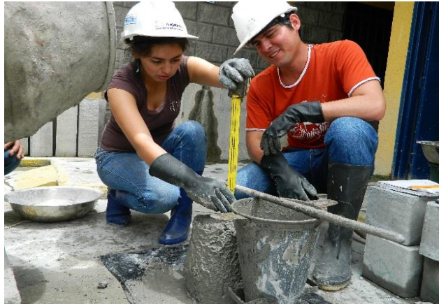
Figura 5. Prueba de asentamiento
