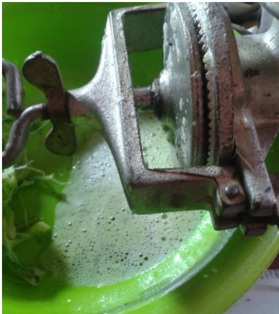
Figura 12. Extracción del licor de fique
