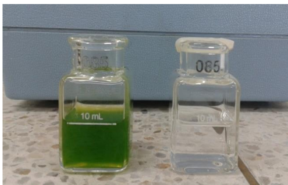
Figura 20. Celdas para pruebas de clorofila
