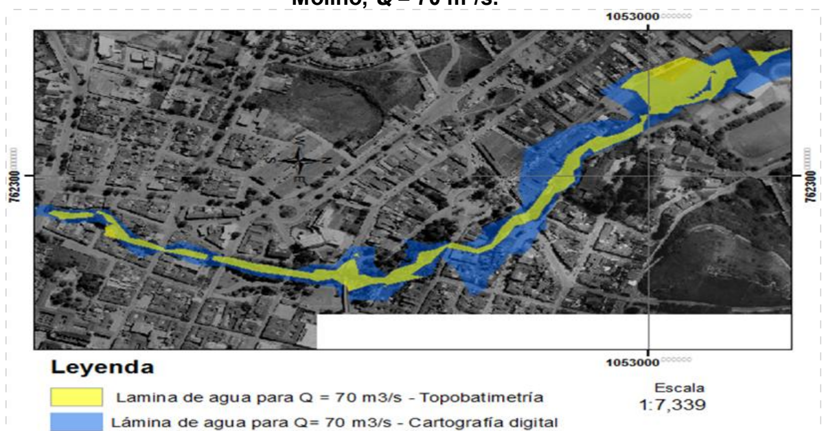
Figura 13.3. Superposición del ancho de inundación para un tramo del río Molino, Q = 70 \text{ m}^3/\text{s} .
