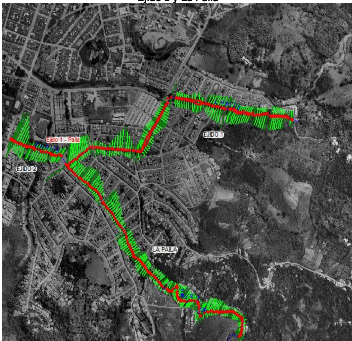
Figura 11.1. Modelo geométrico topobatimétrico de los tramos Ejido 1, Ejido 2 y La Paila
