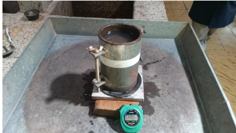
Figura 7.7. Montaje para permeabilidad
