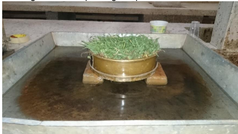
Figura 7.8. Capa Vegetal para Permeabilidad
