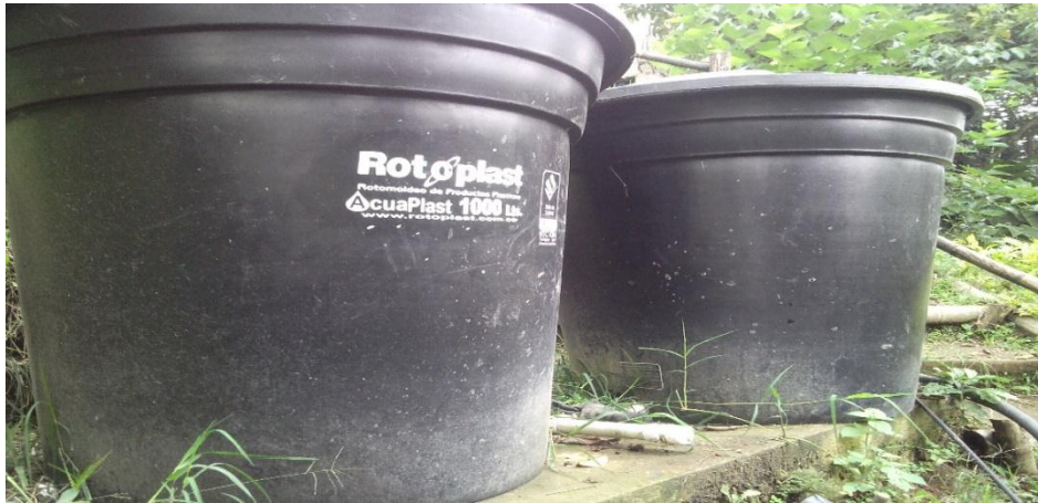
Figura 20. Reactores Hidrolítico/ Acidogénico RHA.
