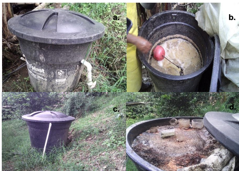
Figura 21. a. Cámara dosificadora en tanque de polietileno de 250 L, b. Parte interna de la cámara dosificadora, c. Parte exterior del reactor metanogénico, d. Botellas plásticas y microorganismos dentro del reactor metanogénico.
