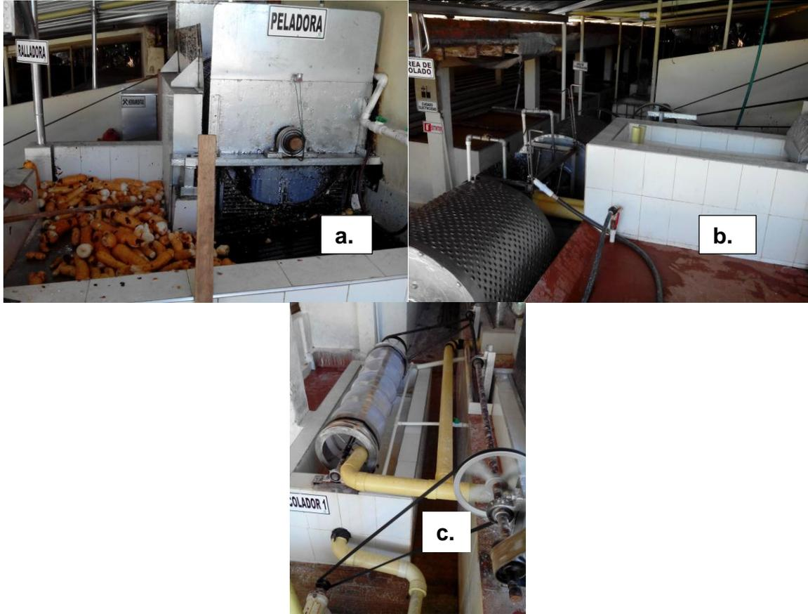
Como se observa en la Figura 7, la distribución por gravedad de la maquinaria en la rallandería El Trébol (alta tecnología); el montaje permite que el proceso sea continuo, lo que facilita el trabajo de los operarios y además optimiza el proceso.
