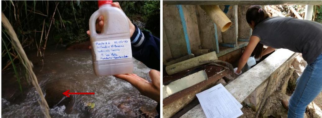
En la figura 3 a la izquierda se aprecia el vertimiento directo sobre la fuente receptora (Quebrada San Pablo) de las aguas residuales del lavado y pelado de la yuca en la rallandería El Provenir; la figura de la derecha muestra el momento en que se toma la muestra a la salida de los canales de sedimentación de mancha.
