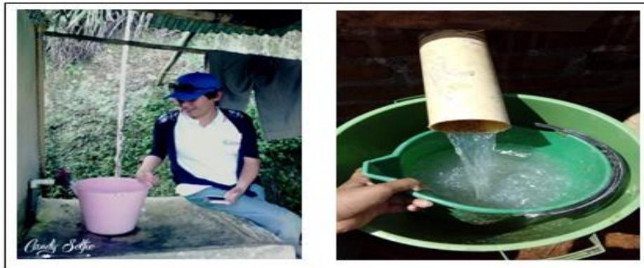
Figura 4. Toma de caudales en las viviendas de algunos asociados.
