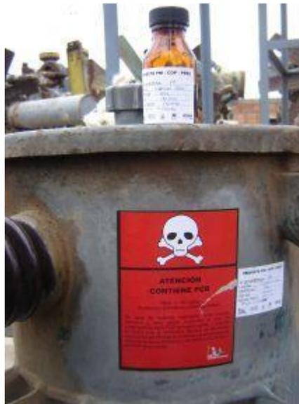
Imagen 7. Equipo contaminado con PCB.
