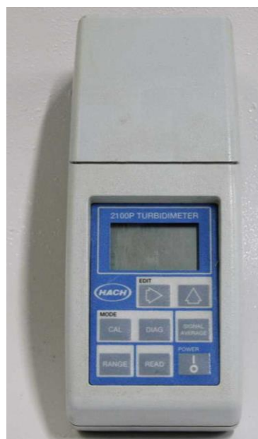
d. Turbidímetro portátil Hach modelo 2100P
