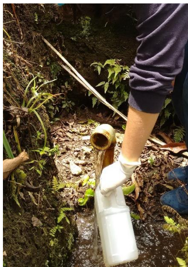
Fotografía 13. Muestreo de las aguas residuales a la salida del sistema Fuente: elaboración propia
