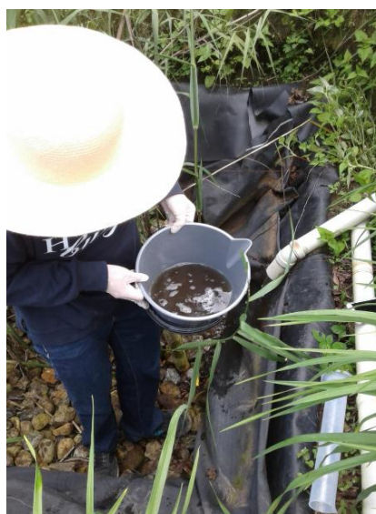
Fotografía 16. Medición del caudal a la entrada del humedal mediante el método volumétrico Fuente: elaboración propia
