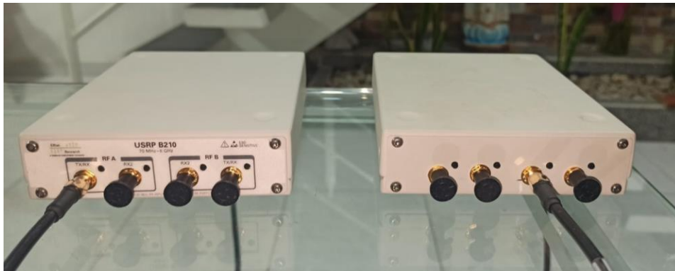
Figura 52. Placas USRP Comunicación Cableada.
