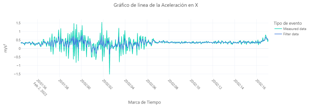
Figura 25. Eliminación de ruido mediante el uso del Filtro Kalman
