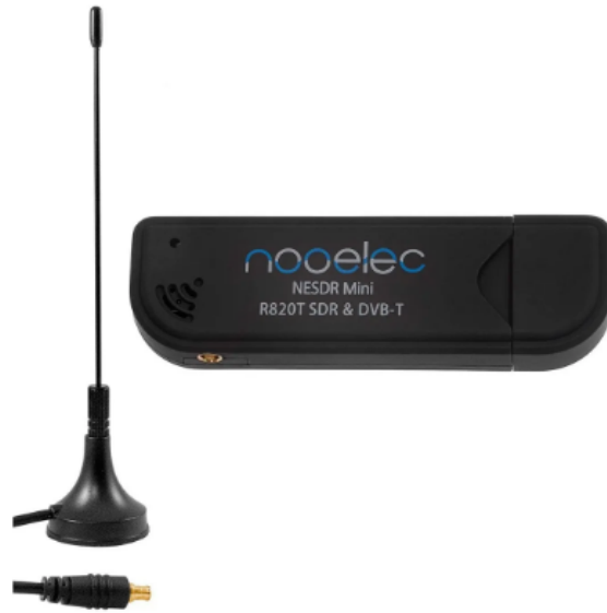
Figura. 2.2. Dispositivo RTL SDR.
