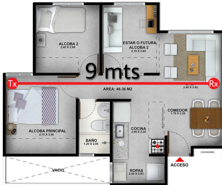
Figura. 3.8. Ubicación de Transmisor y Receptor a 9 mts. de distancia en ambiente indoor con LOS.
