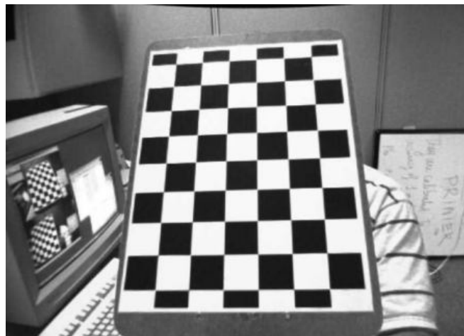
Figura C.2: Tablero de ajedrez con distorsión corregida (Tomado de [187]).
