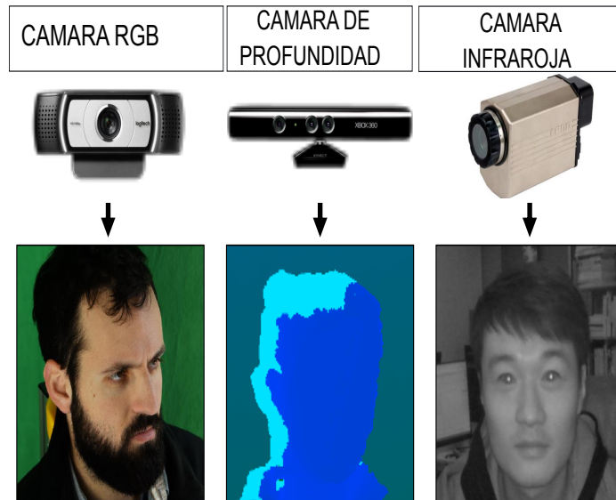
Figura 2.3: Tipos de cámaras e imágenes capturadas (Tomado de [95]).
