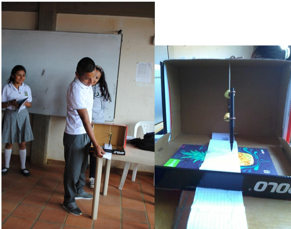
Figura 9. Estudiantes exponiendo su primer prototipo para medición de vibraciones generadas por el tránsito vehicular.
