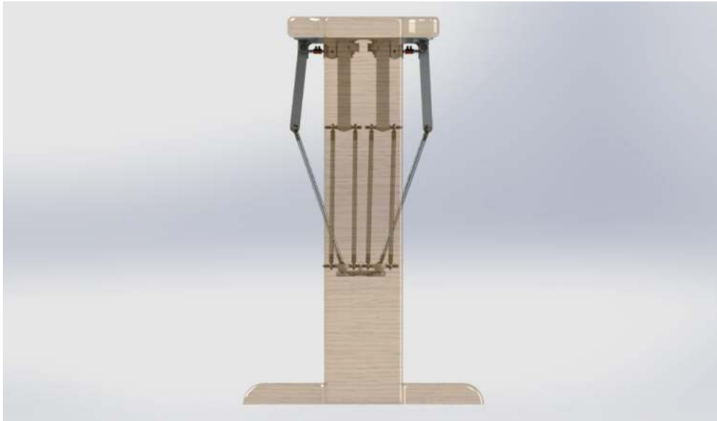
Figura 4.21: Robot H4 propuesto, vista trasera.
