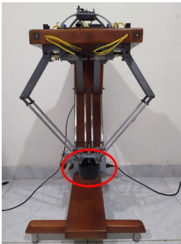
Figura 5.37: Disposición de la masa adicional
