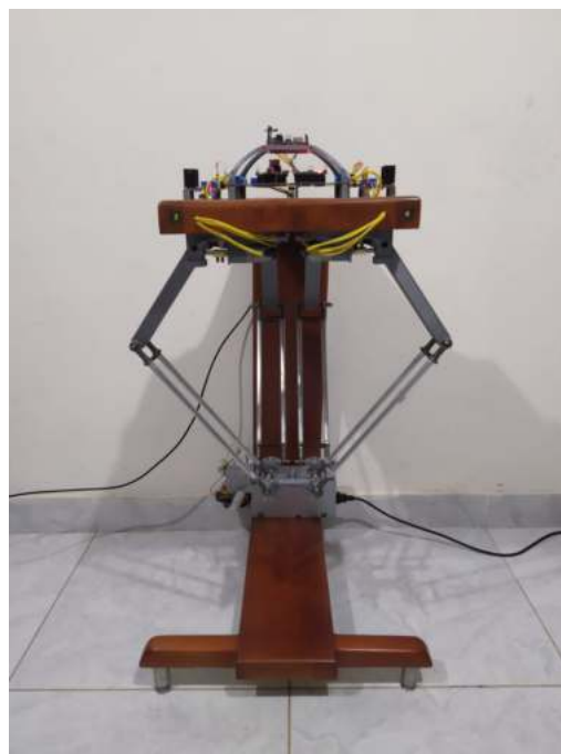
Figura 4.68: Robot H4 implementado, vista frontal.
