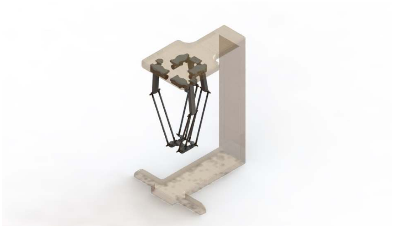
Figura 4.17: Robot H4 propuesto, vista isométrica con transparencia en base rígida.
