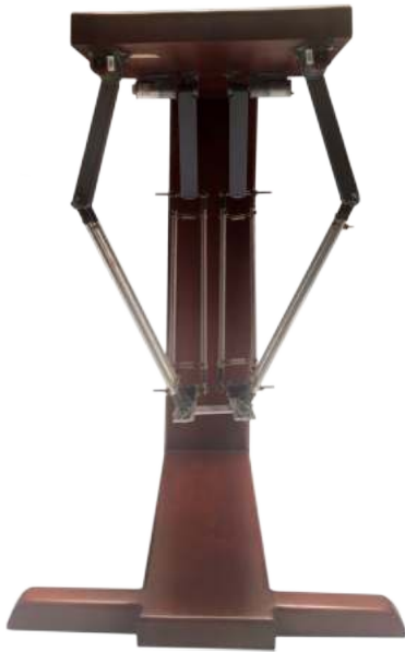
Figura 4.44: Vista de los soportes, antebrazos y motores (Vista Frontal)
