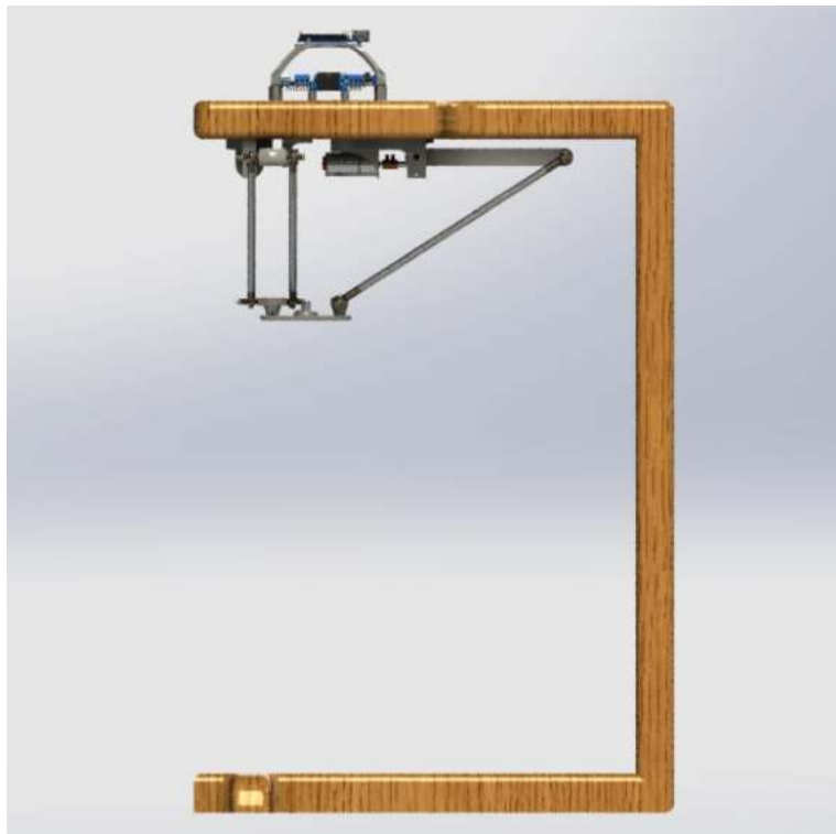
Figura 5.2: Robot H4 propuesto en posición inicial, vista lateral.
