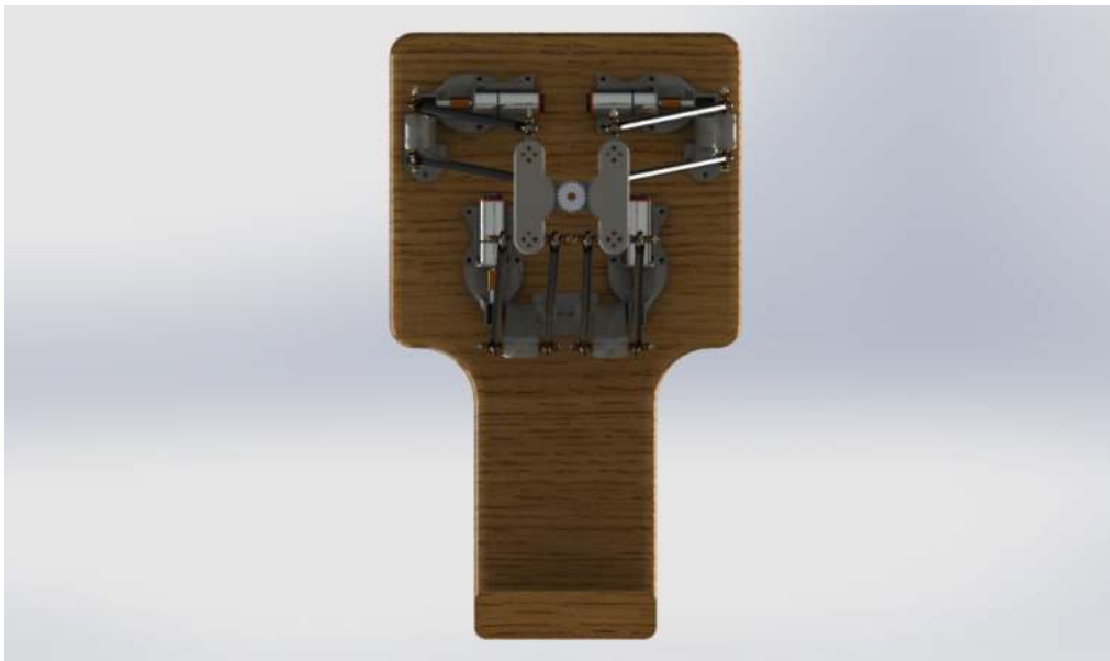
Figura 4.22: Robot H4 propuesto, vista inferior.
