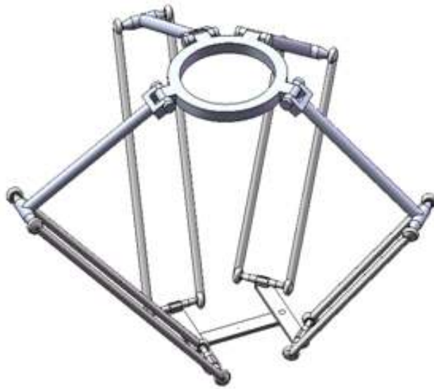
Figura 2.6: Robot H4 con 4 juntas rotacionales [34]
