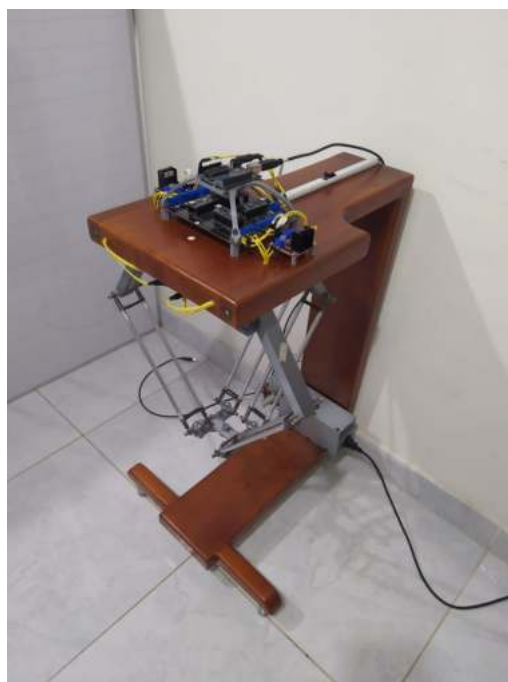
Figura 4.70: Robot H4 implementado, isométrica.
