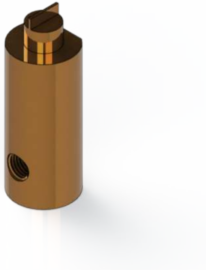
Figura 4.7: Alma del antebrazo modelado en 3D renderizado
