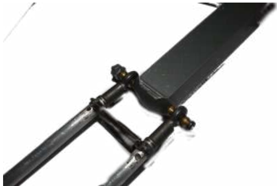
Figura 4.47: Acople barras paralelas extremo superior
