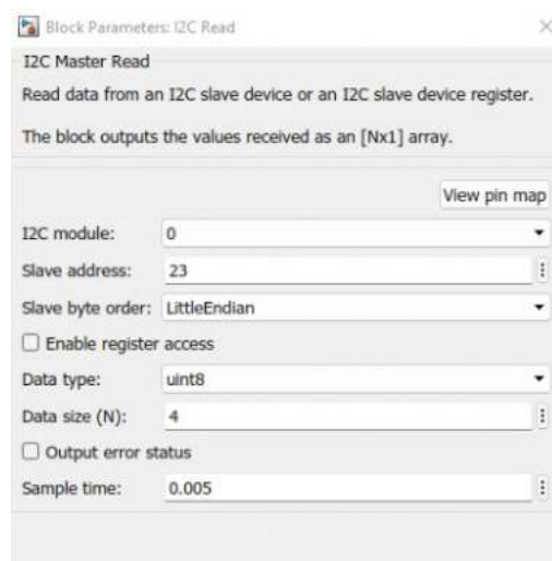
Figura 4.54: Configuración bloque “Master read”
