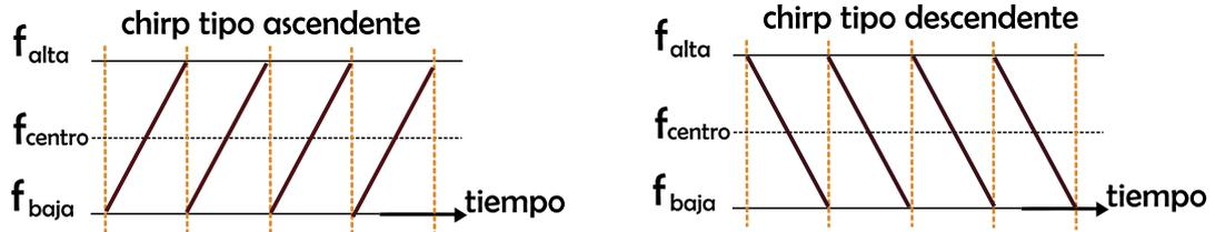
Fig. 10. Frecuencia de un pulso tipo chirp en el dominio del tiempo. Tomada de [17].
