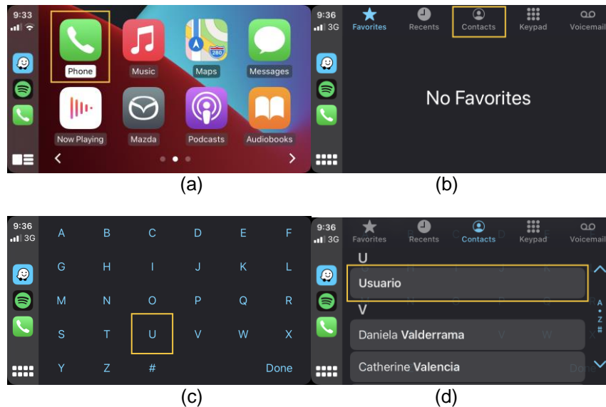
Figura 60. Flujo para llamar al contacto Usuario haciendo uso del menú intermedio de letras
