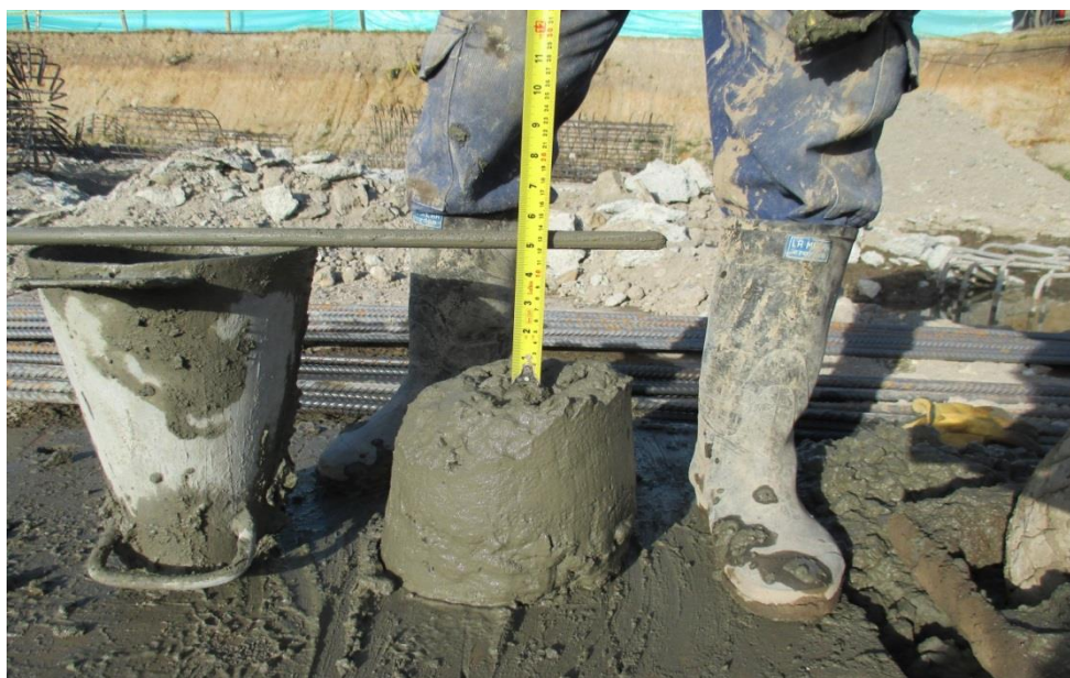
Figura N° 11. (Rojas C, 2018) Medición del asentamiento del concreto mediante la prueba del slump. Foto tomada en sitio
