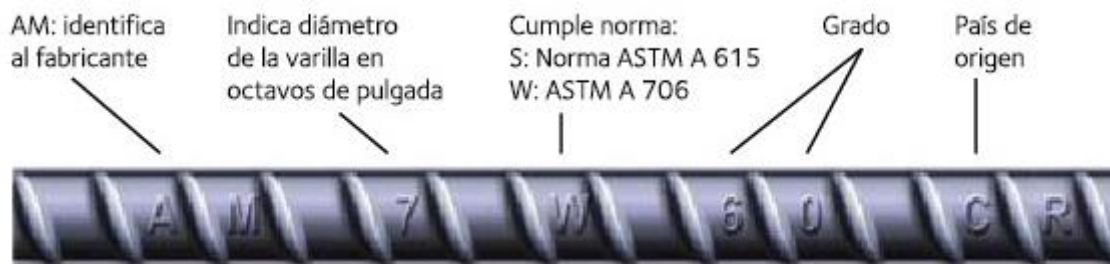
Figura N° 7. (Construplaza, 2019) Descripción de marcación de las barras corrugadas de acero. Imagen tomada de la página principal de la empresa: https://www.construplaza.com/Materiales/Aceros/Varillas-para-Construccion/Varilla-deformada-grado-60-
