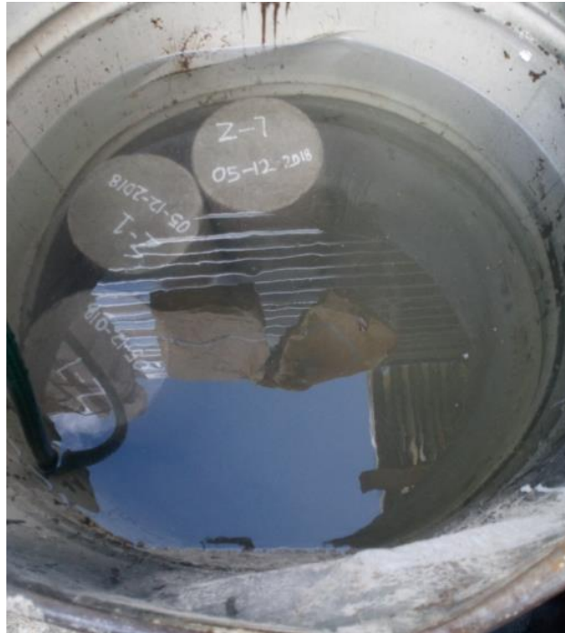
Figura N° 12. (Rojas C, 2018) Curado de especímenes de concreto. Foto tomada en sitio
