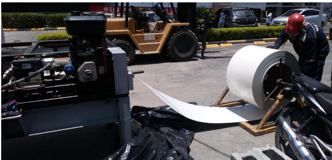
Figura N° 32. (Rojas C, 2019) Fabricación de lámina para cubierta. Foto tomada en sitio
