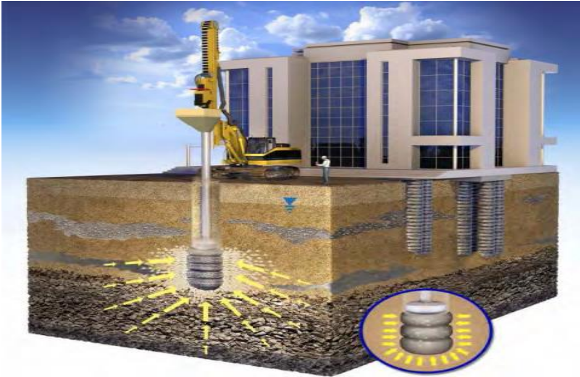
Figura 13 – Confinamiento lateral del suelo circundante a la columnas de grava apisonadas.
