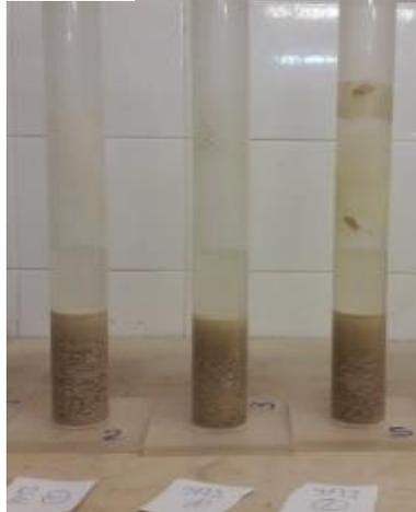
La muestra es entonces "irrigada", usando una cantidad adicional de solución de trabajo, para forzar el material arcilloso a quedar en suspensión encima de la arena hasta completar una altura de 15 pulgadas o 381 mm. Después de 20 minutos en un período de sedimentación, se determinan las alturas de la arcilla floculada y de la arena en el cilindro.
