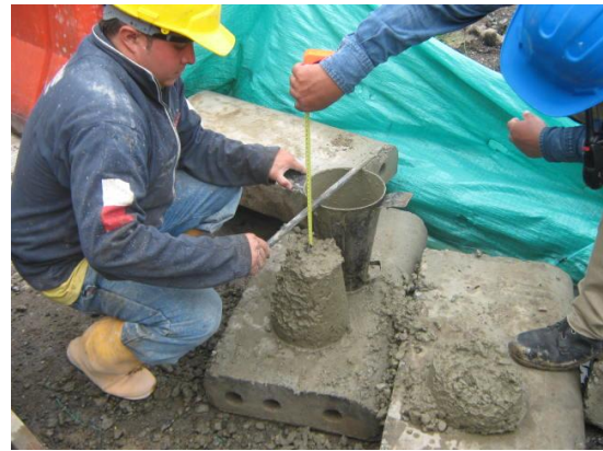
Foto #39 ensayo de asentamiento
