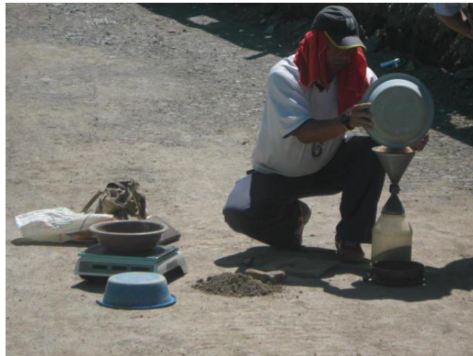
Foto #16 toma de densidades por medio del ensayo de cono y arena
