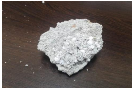
Figura 47 Muestra de mortero con icopor
