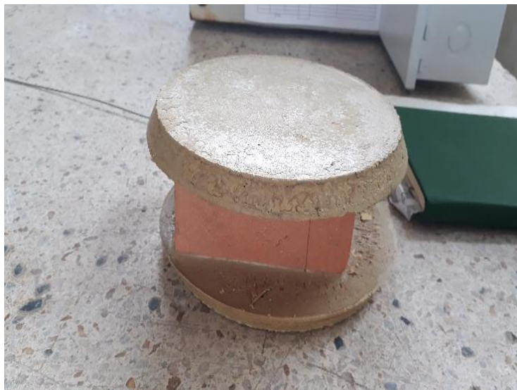
Ilustración 22. Refractado par ensayo a compresión.
