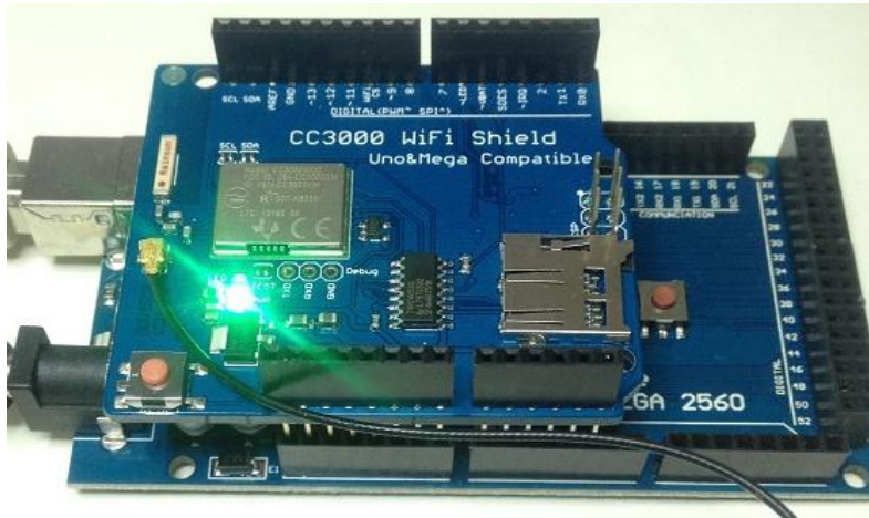
Figura 38. Montaje de acople de Modulo CC300. (Fuente Propia).
