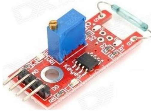
Figura 28. Modulo Sensor Arduino KY-025. (Fuente Libro de descripción de Sensores y Actuadores Compatibles con Arduino-Keyes Robot)
