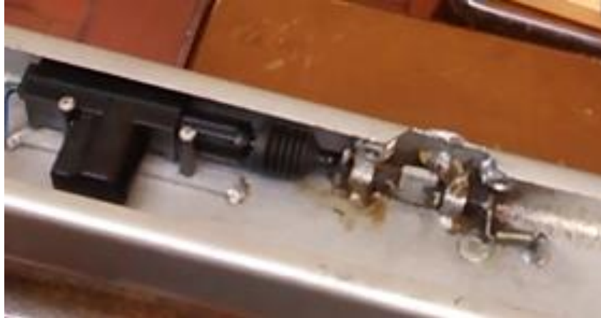
Figura 41. Conexión Solenoide-Cerradura Mecánica. (Fuente Propia).
