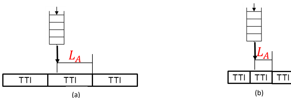
Figura 3.6. Retardo de alineación. a) TTI grande b) TTI corto.
