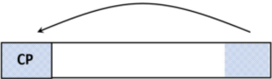
Figura 1.5. Prefijo cíclico en CP-OFDM. Tomada de [14]
