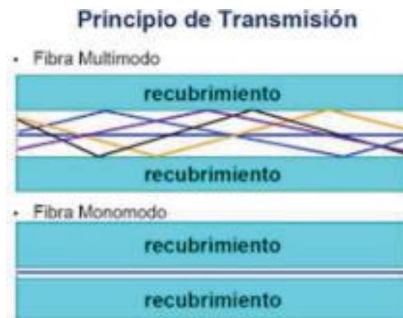
Figura 2.9: Tipos de Fibra Óptica según principio de transmisión. Tomada de [12].
