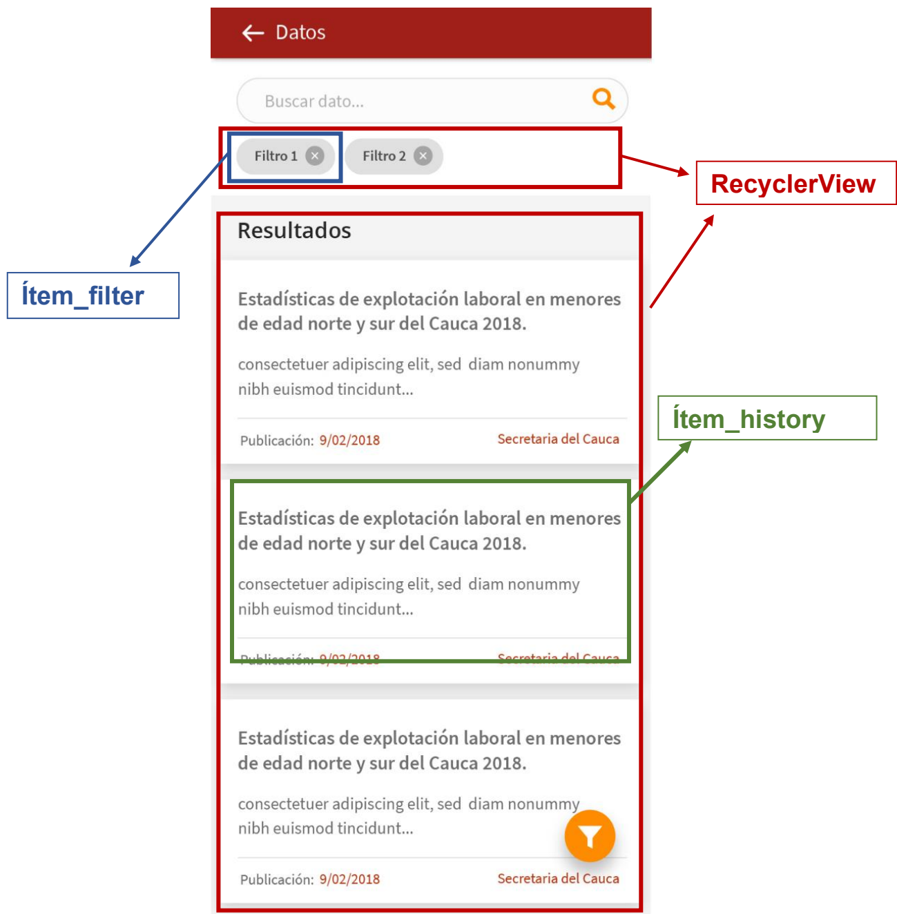
Figura 44. Identificación de componentes que requieren un adaptador.
