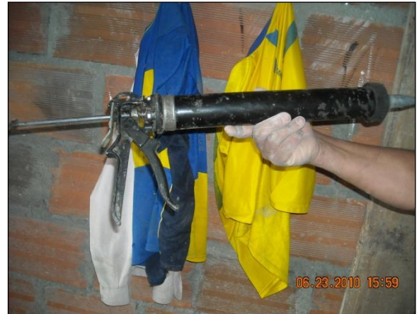
Fig. 40. Pistola de émbolo para aplicar sikaflex256.
