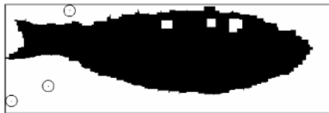
Figura 2.15. Opening de la imagen anterior (los círculos han sido dibujados manualmente para identificar los puntos).
