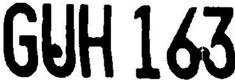
Figura 4.10. Placa después de eliminar los pequeños componentes y separación de los caracteres 6 y 3.
