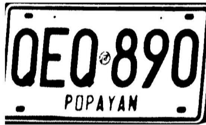
Figura 4.3 Umbralización con el método de Otsu
