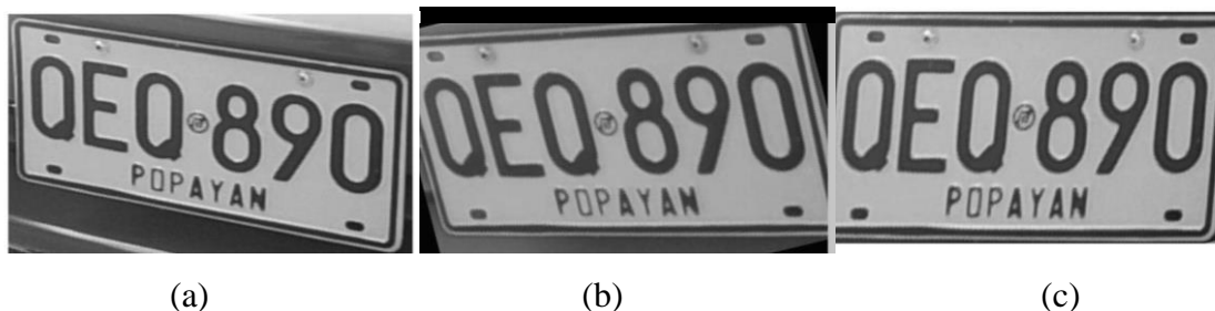
Figura 4.2. Corrección de ángulo, (a) imagen obtenida de la detección, (b) imagen girada 7 grados, (c) imagen obtenida aplicando una transformación espacial.
