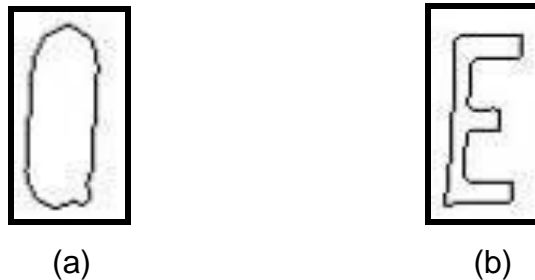
Figura. 5.9. Área exterior de los bordes, (a) longitud de borde 136, (b) longitud de borde 199.
