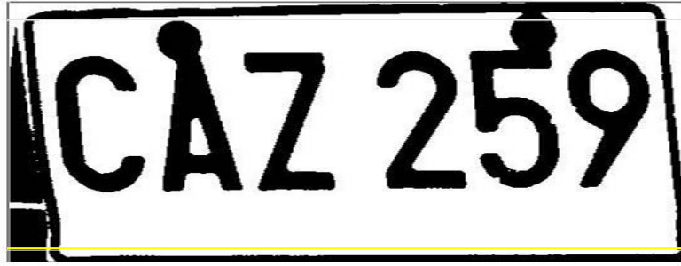
Figura 4.9. Caracter unido al marco de la placa con las líneas de separación
