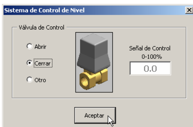
Figura 72. Panel de manejo de la válvula de control.
