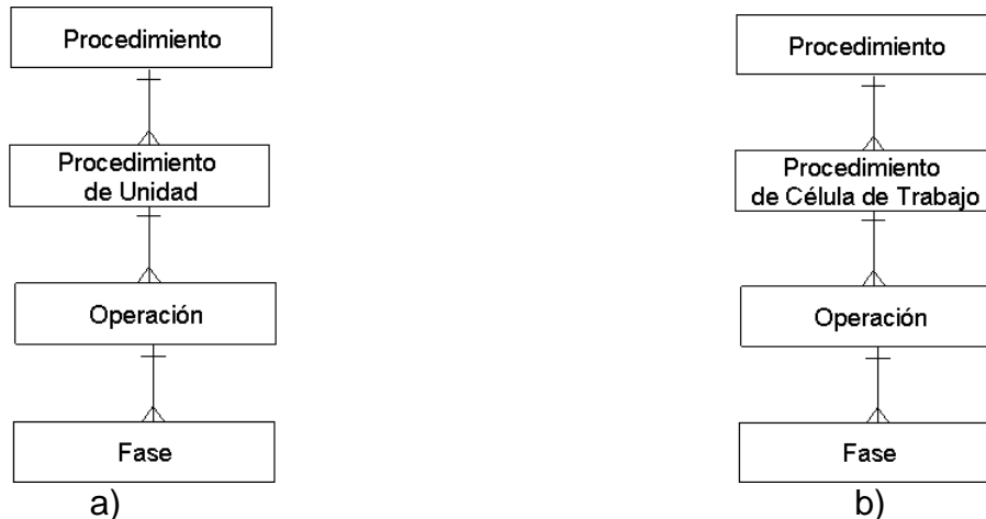
Figura 43. Modelo de control Procedimental, a) según la Norma ISA 88, b) adecuado a procesos discretos.
