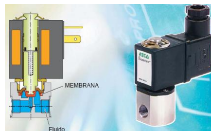
Figura 3.17: Electroválvula de membrana.
