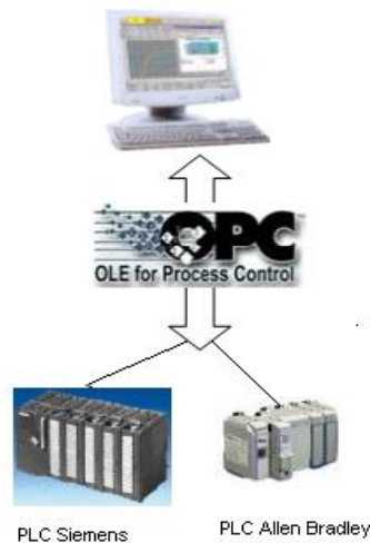
Figura 13. Arquitectura inicial del sistema
