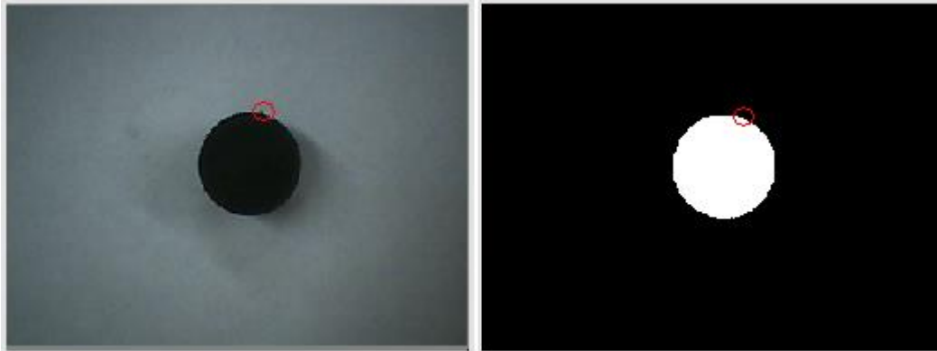
Figura 3.21. Imagen filtrada. En el círculo rojo de la imagen izquierda se observa unos cuantos píxeles que se entienden como ruido en la detección del objeto, y en la parte derecha se observa el objeto umbralizado y libre de ruido.
