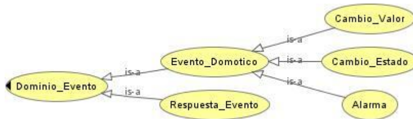
Figura 10 Diagrama de conceptos del dominio de Eventos, elaborado en el editor de ontologías Protégé
