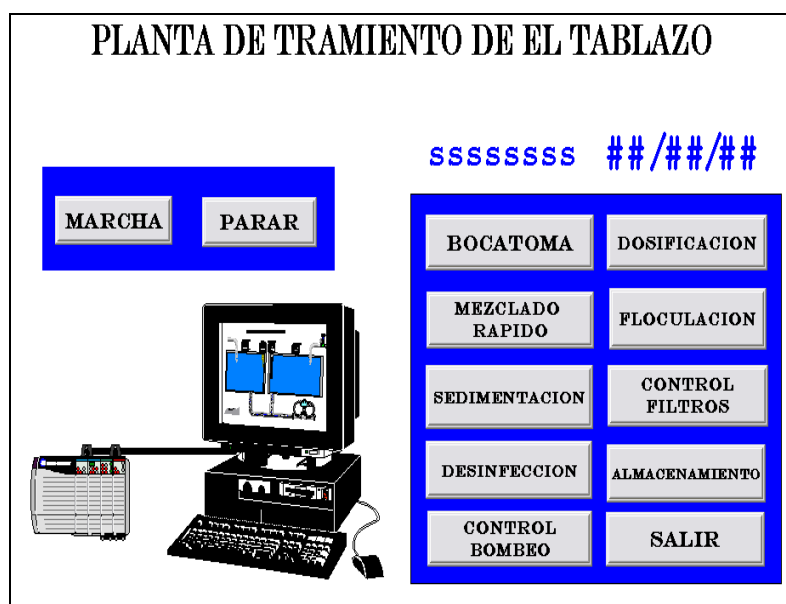
Figura 19: Pantalla principal del SCADA de la planta de tratamiento del Tablazo
