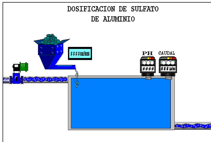
Figura 21: Etapa de dosificación de sulfato de aluminio.
