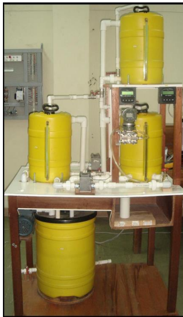
Figura 5: Planta de tanques interactuantes
