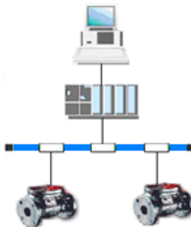
Figura 21. Red de control de válvulas planta El Tablazo.
