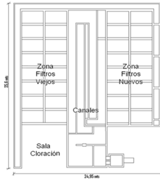
Figura 34. Plano arquitectónico - Filtros Planta El Tablazo
