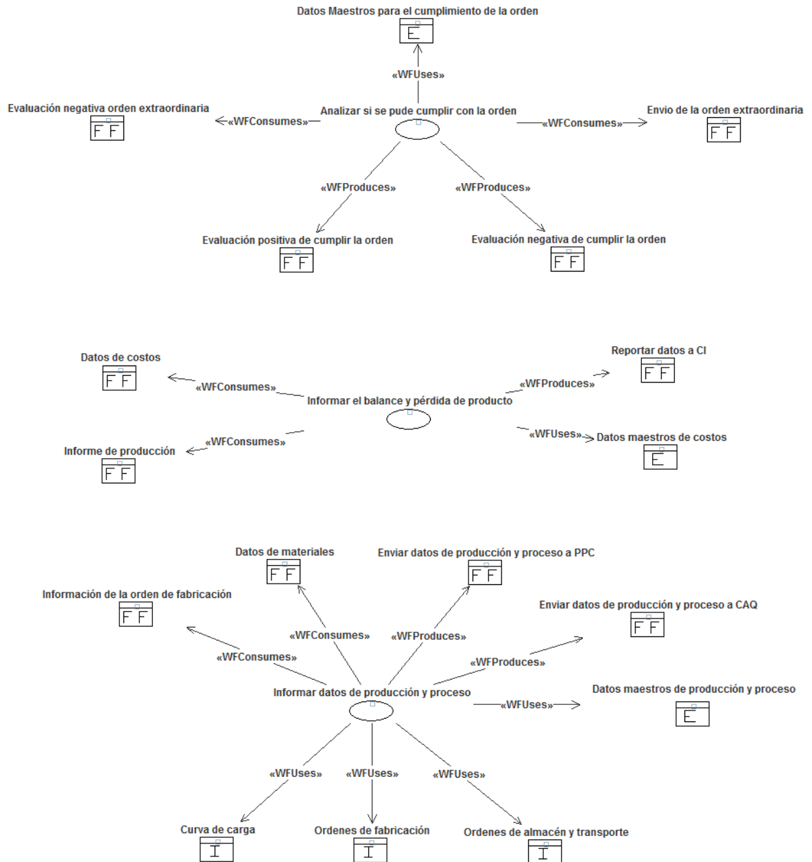
Figura 146: Asociación del entorno y las tareas del agente administrador de la orden.
