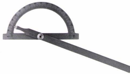
Figura E 3. Transportador utilizado para medir el ángulo de inclinación del ducto.
