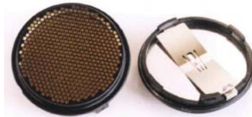
Figura 2.2. Capsula emisora o receptora de un sensor de ultrasonido.
