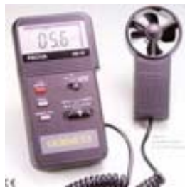
Figura E 1. Anemómetro utilizado para registrar las velocidades a la salida del actuador.
