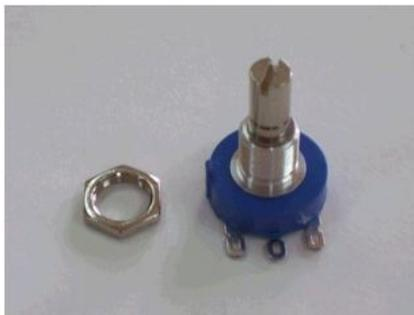
Figura B5. Potenciómetro utilizado.
