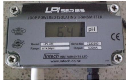
Figura 3.4b Transmisor indicador de pH *Intech*, envía 4-20mA al PLC e indica el valor de pH.
