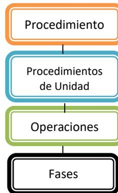
Figura 2.8. Modelo de control procedimental [1].
