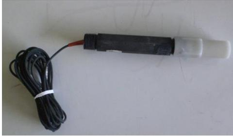
Figura 1.13 Vista superior del sensor de pH. Fuente propia
