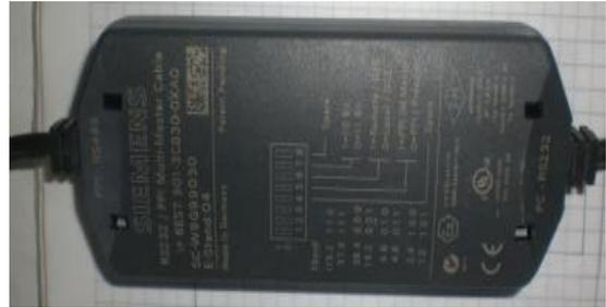
Figura 3.6a Cable de comunicación siemens de referencia PPI-RS 485/PC-RS 232, utilizado para realizar la comunicación entre el PLC y el PC.
