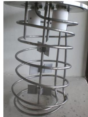
Figura 3.5b Eje del servomotor, el cual tiene 3 aspas planas para agitar la suspensión, las aspas son móviles de acuerdo a la cantidad de suspensión que se vaya a preparar.
