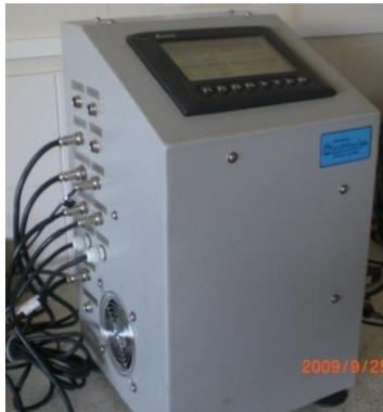
Figura 3.6b Armario de control Centricol, cuenta con una pantalla táctil Delta Electronics y en el costado derecho con conectores para los instrumentos y actuadores e internamente un PLC Siemens.
