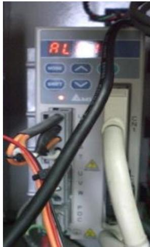
Figura 3.5c ACServo Variador Delta Electronics Inc, utilizado para regular la potencia del servomotor.
