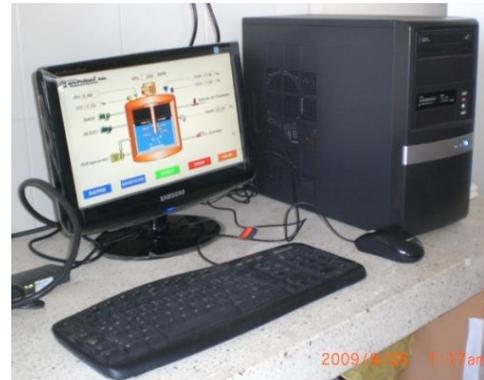
Figura 3.6c Equipo de Monitoreo y supervisión. Este cuenta con un HMI de la empresa Siemens, SIMATIC WinCC Flexible 2007.
