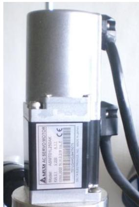
Figura 3.5a Servomotor y *encoder Delta Electronics Inc*, utilizado para agitar la suspensión dentro del Biorreactor y realimentar la velocidad de agitación, en el rango (0, 300) RPM.
