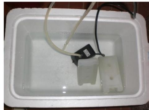
Figura 3.3b Baño de enfriamiento, incluye nevera de icopor de 43lt, se observa la bomba sumergible, pilas de frío y mangueras de circulación de agua en el serpentín.
