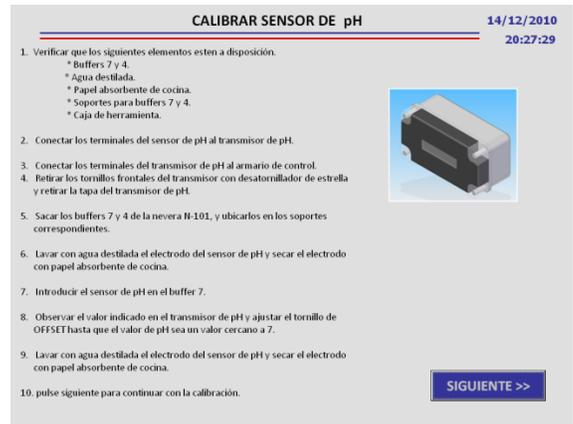
Figura 4.10 Interfaz 8, O4.1. Sensor-transmisor de pH. Fuente propia.
