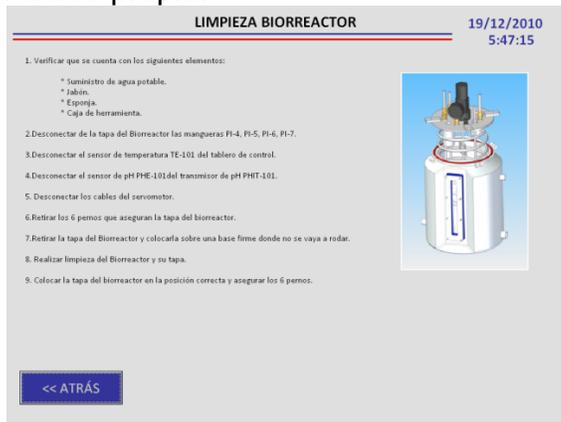
Figura 4.5 Interfaz 3, E1. Limpiar Biorreactor. Fuente propia.
