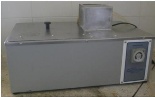
Figura 3.2c Baño termostático Centricol, cuenta con depósito de agua, una bomba sumergible, una resistencia eléctrica y una perilla de configuración de potencia para la resistencia.
