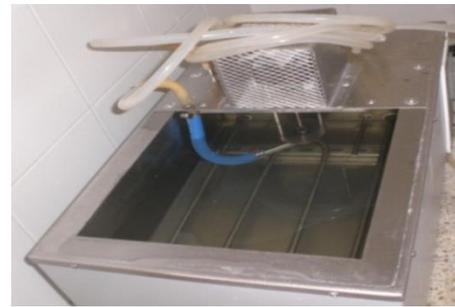
Figura 3.2d Vista superior del baño termostático, se observa la resistencia eléctrica, la bomba sumergible, el depósito de 13lt y las mangueras de circulación de agua en la doble chaqueta del Biorreactor.
