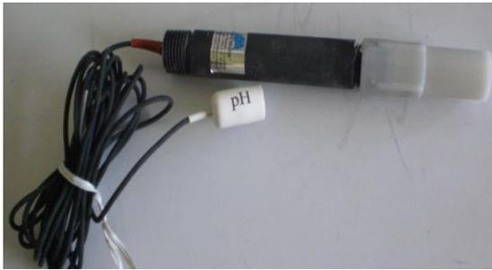
Figura 3.4a Sensor de pH *Instrumatic*, utilizado para medir el pH de la suspensión dentro del Biorreactor.
