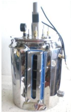
Figura 3.1a Biorreactor en acero inoxidable de 5Lts con doble chaqueta por donde circula agua caliente. Marca Centricol.
