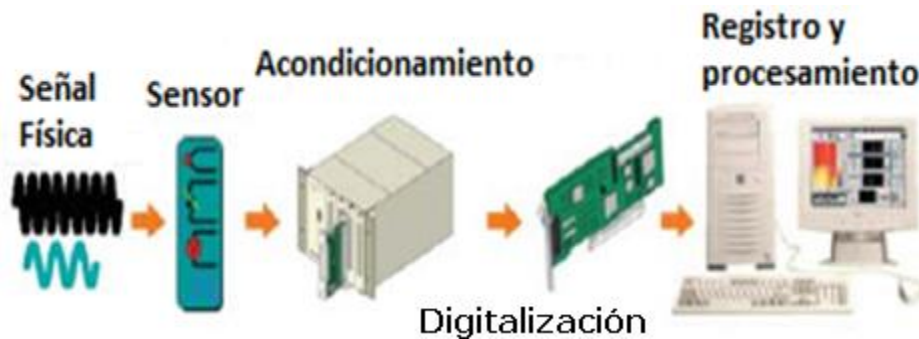
Figura 3.2: Diagrama General de un sistema adquisición de datos [11]
