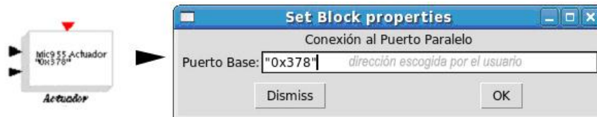
Figura 51: Bloque Mic955 Actuador y parámetros
