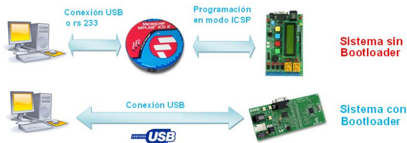
Figura 2.12. Programación con programador hardware externo vs. Programación con bootloader integrado.
