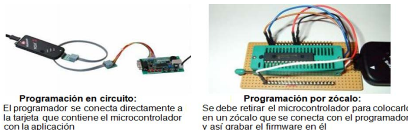
Figura 1.4. Programación en circuito Vs Programación por zócalo.
