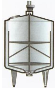
Figura A.11. Tanque de proceso aislado con agitador
