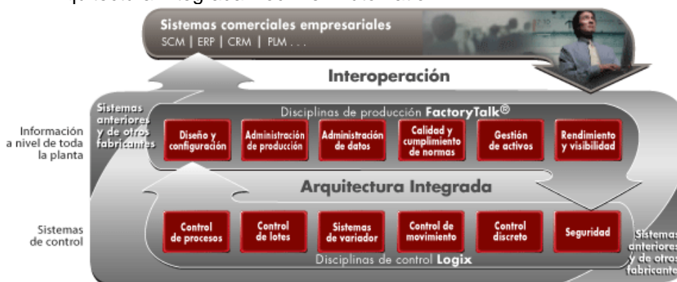
Figura F.4. Arquitectura Integrada Rockwell Automation
